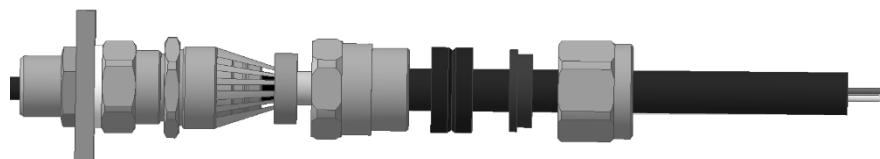
Постоянно надавливая на кабель, затяните нажимную гайку (4, АК2) до упора (с минимальным моментом 20Н\*м). Проверить закрепление брони.
