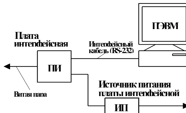
Рис. 12. Схема подключения центрального компьютера.
