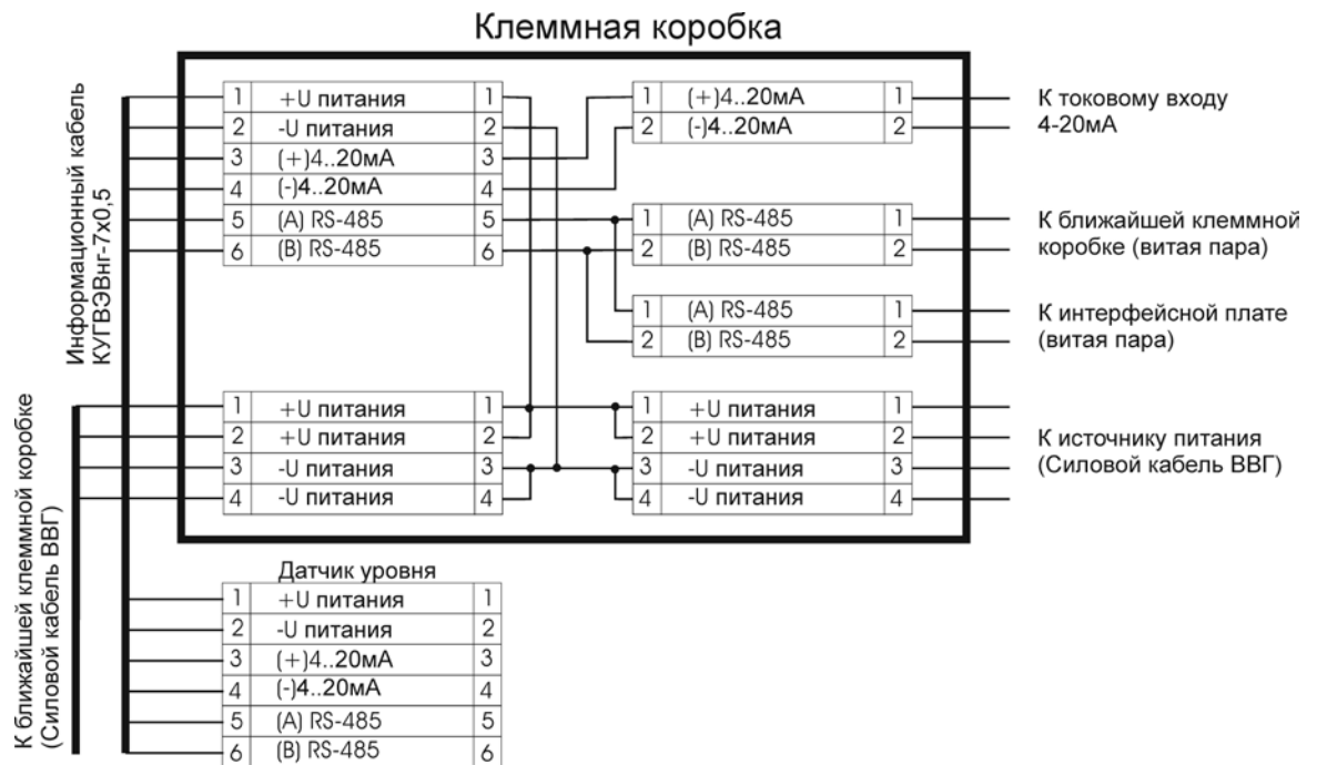
Рис. 10. Типовая схема подключения датчика уровня в кабельную сеть.
