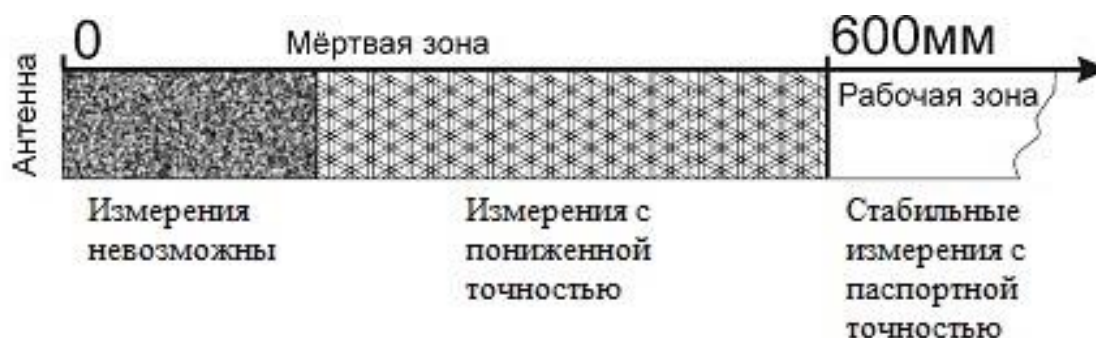
Рис. 4.5 Мертвая зона уровнемера.
