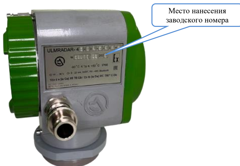
Рисунок 1 – Общий вид уровнемеров радиоволновых ULMRADAR-4
