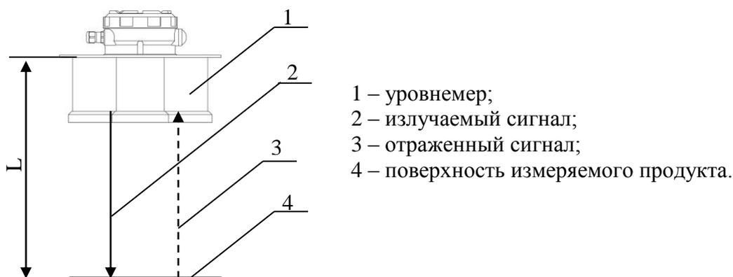
Рис. 3.5. Принцип измерения
