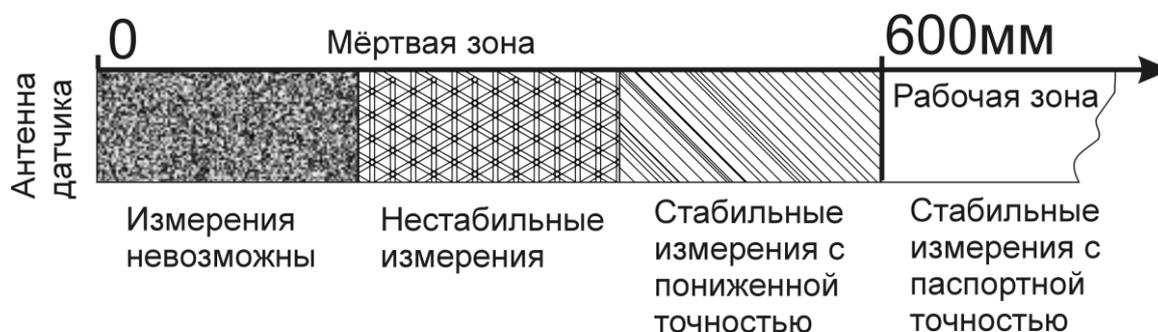
Рис. 4.9. Мертвая зона прибора
