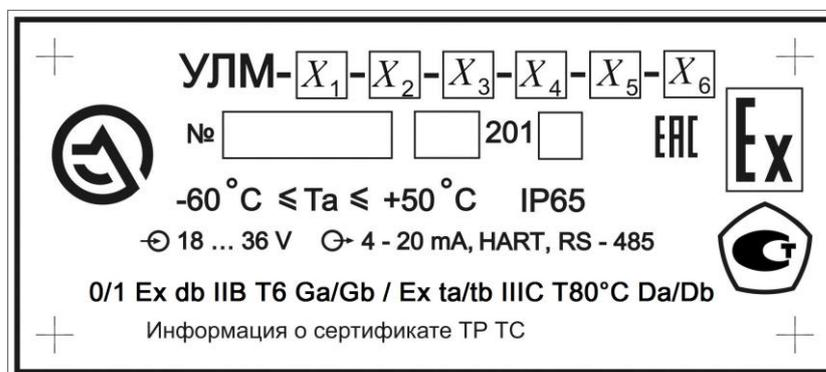
Рис. 3.3. Типовой шильдик.
