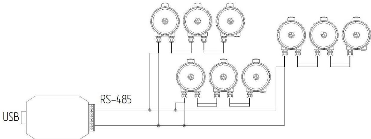
Рис. 6.5 Способ прокладки линии RS-485 «звезда»
