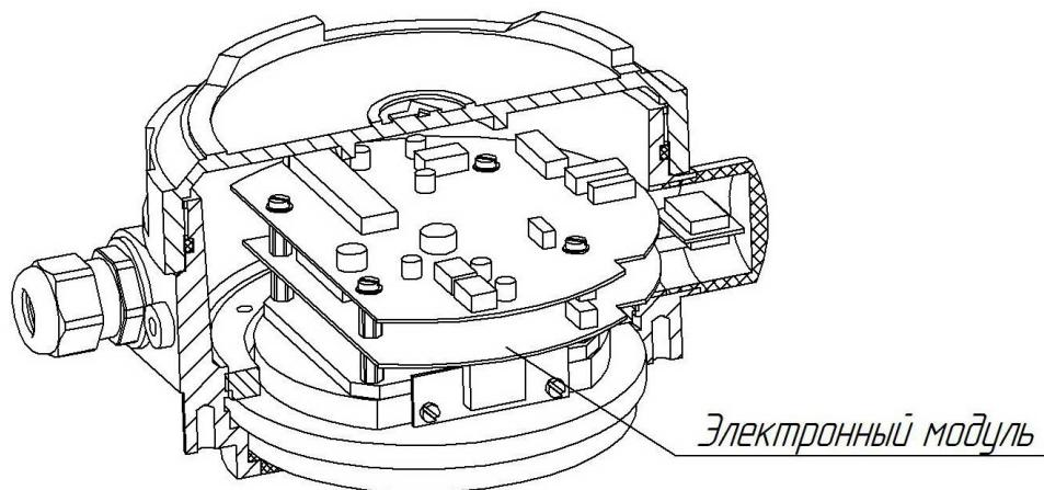
Рис. 3.5. Конструкция уровнемера. Расположение электронного модуля.
