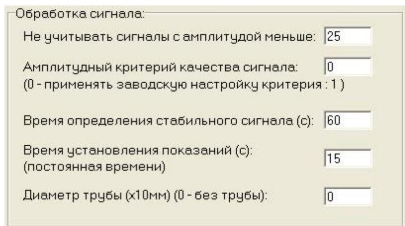
Рис. 6.11 Настройка параметров обработки сигнала
