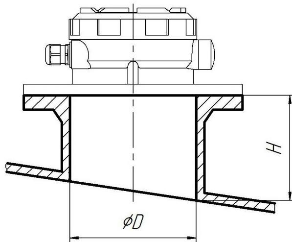
Рис. 4.9. Установка прибора на монтажный патрубок.
