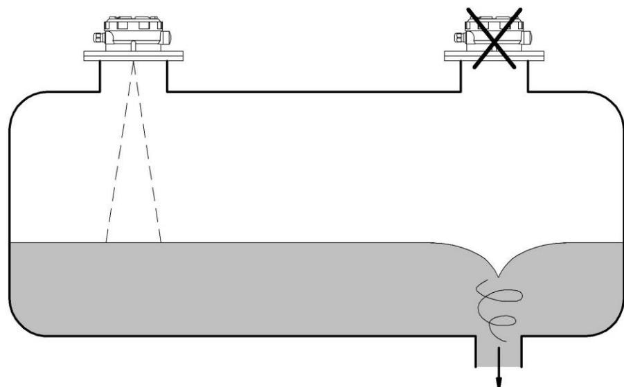
Рис. 4.3. Установка прибора на резервуаре. Выгрузка продукта.
