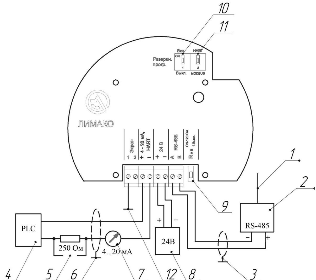
Рис. 5.7 Подключение уровнемера модификации УЛМ-31А1-ХФ-Ф-ЛС.
