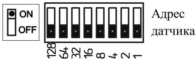
Рис. 6.1. Переключатель адреса в положении все нули
