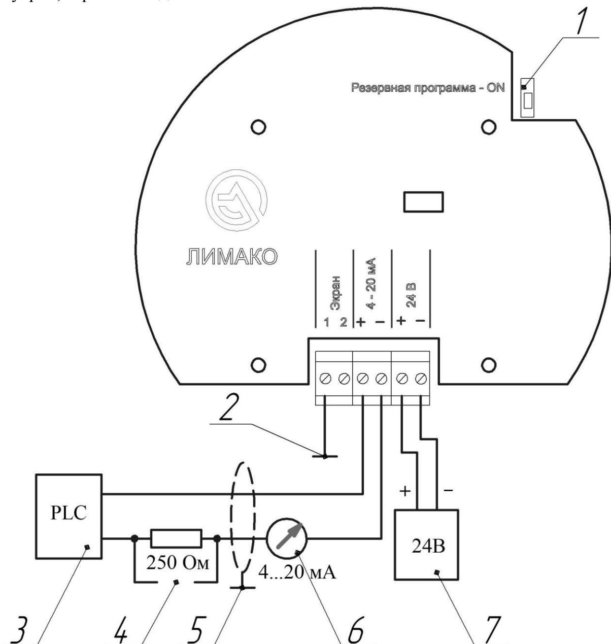
Рис. 5.6 Подключение уровнемера модификации УЛМ-31А1-HF-F-LC.
