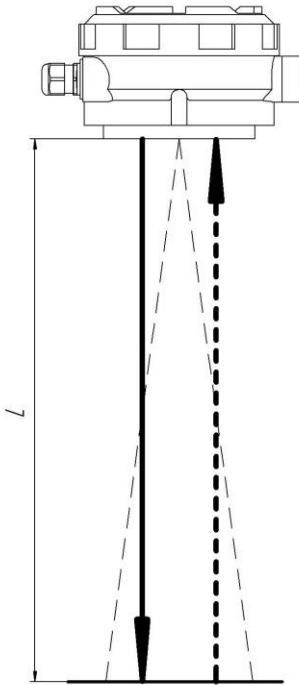
Рис. 3.8. Принцип измерения.
