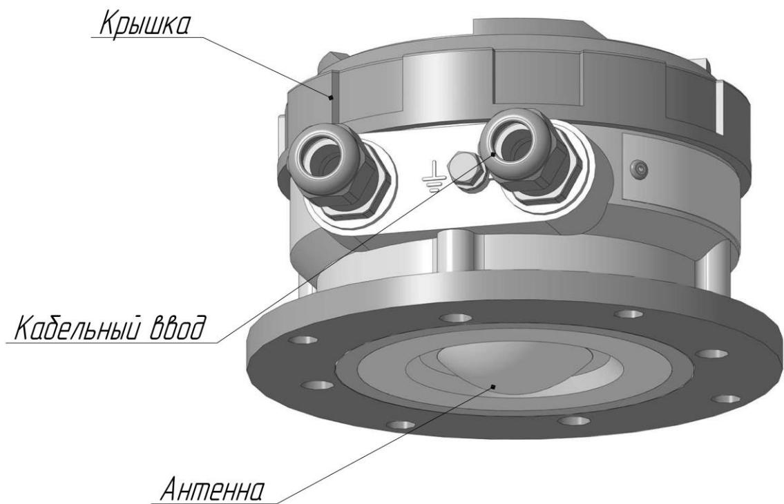
Рис. 3.3. Внешний вид и расположение основных элементов уровнемера УЛМ-31-HF-F, УЛМ-31A1-HF-F и УЛМ-31A1-HF-F-LC. Алюминиевый корпус.
