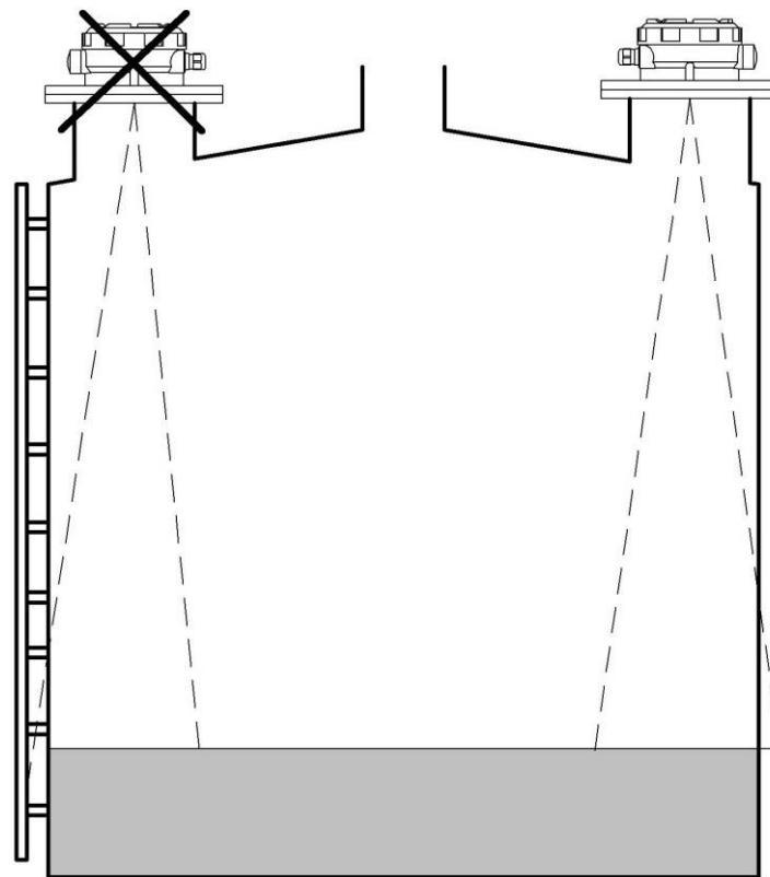
Рис. 4.8. Установка прибора. Резервуар из непроводящего материала.
