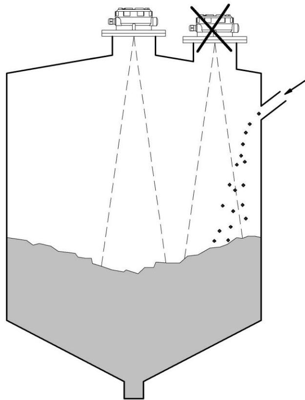
Рис. 4.2. Установка прибора на резервуаре. Подача продукта.
