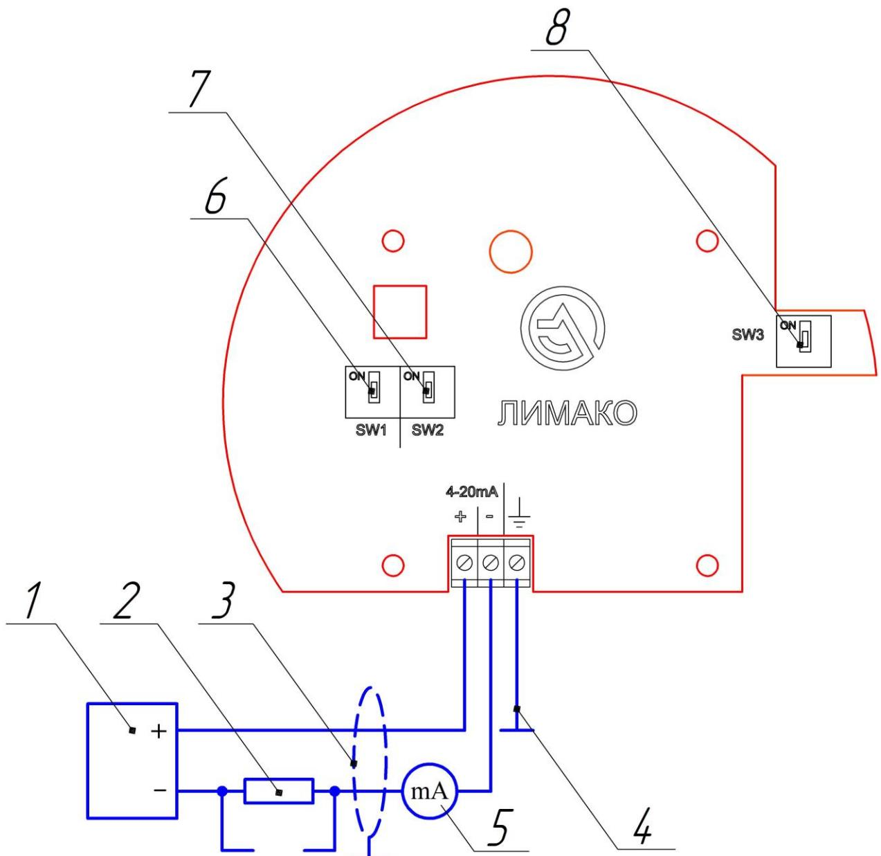
Рис. 5.8 Подключение уровнемера модификации УЛМ-31А1-HF-F-LC.
