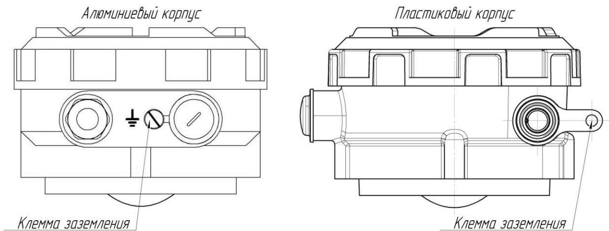
Рис. 5.2 Клемма заземления
