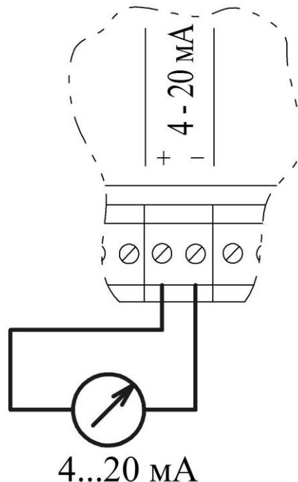
Рис.6.12 Схема включения токового выхода 4-20mA
