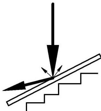
Рис. 4.13. Пример наклонного отражателя над конструкцией в резервуаре
