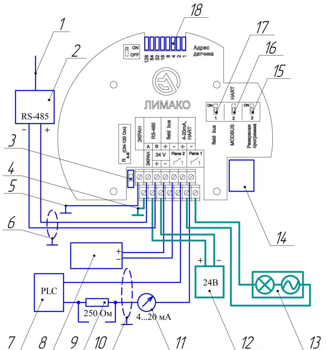
Рис. 5.5 Подключение уровнемеров УЛМ-31А1, УЛМ-31-HF, УЛМ-31-HF-F, УЛМ-31A1-HF и УЛМ-31A1-HF-F. Вариант 3.
