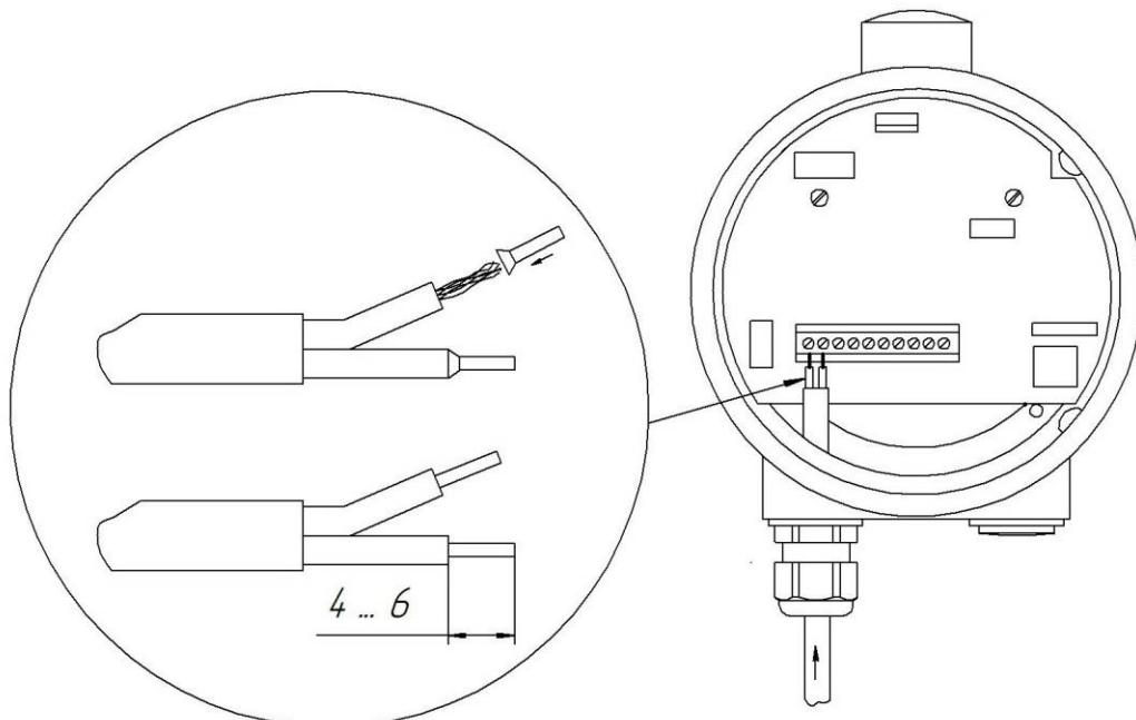
Рис. 5.12 Подключение уровнемера.
