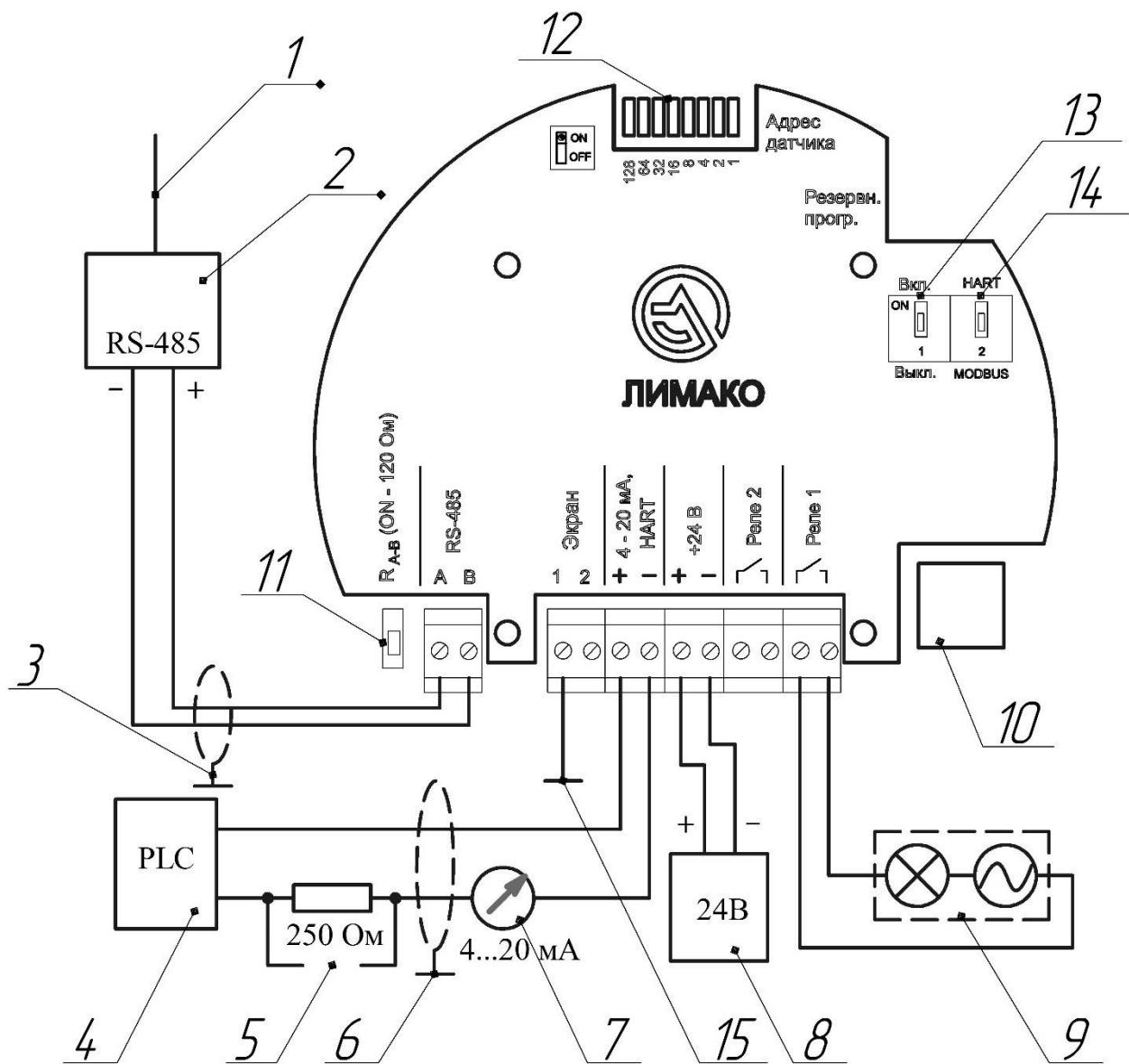
Рис. 5.4 Подключение уровнемеров УЛМ-31А1, УЛМ-31-HF, УЛМ-31-HF-F, УЛМ-31A1-HF и УЛМ-31A1-HF-F. Вариант 2.
