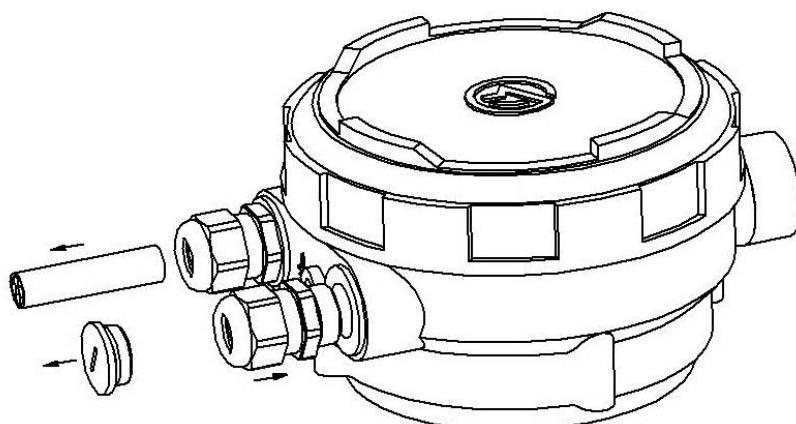
Рис. 5.11 Установка второго кабельного ввода
