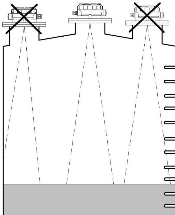
Рис. 4.1. Установка прибора на резервуаре. Конструктивные элементы
