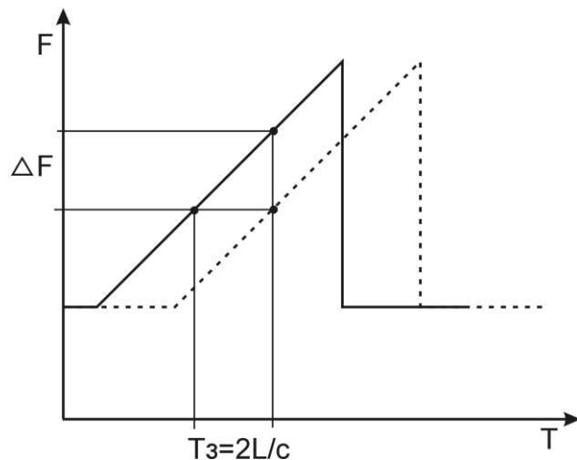
Рис. 3.9. Принцип работы ЛЧМ радиолокатора
