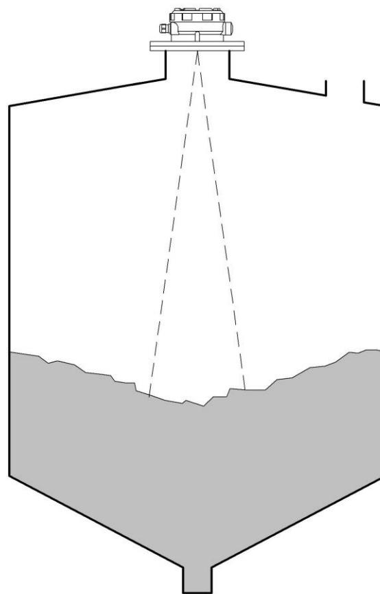
Рис. 4.4. Установка прибора на бункере с коническим дном.
