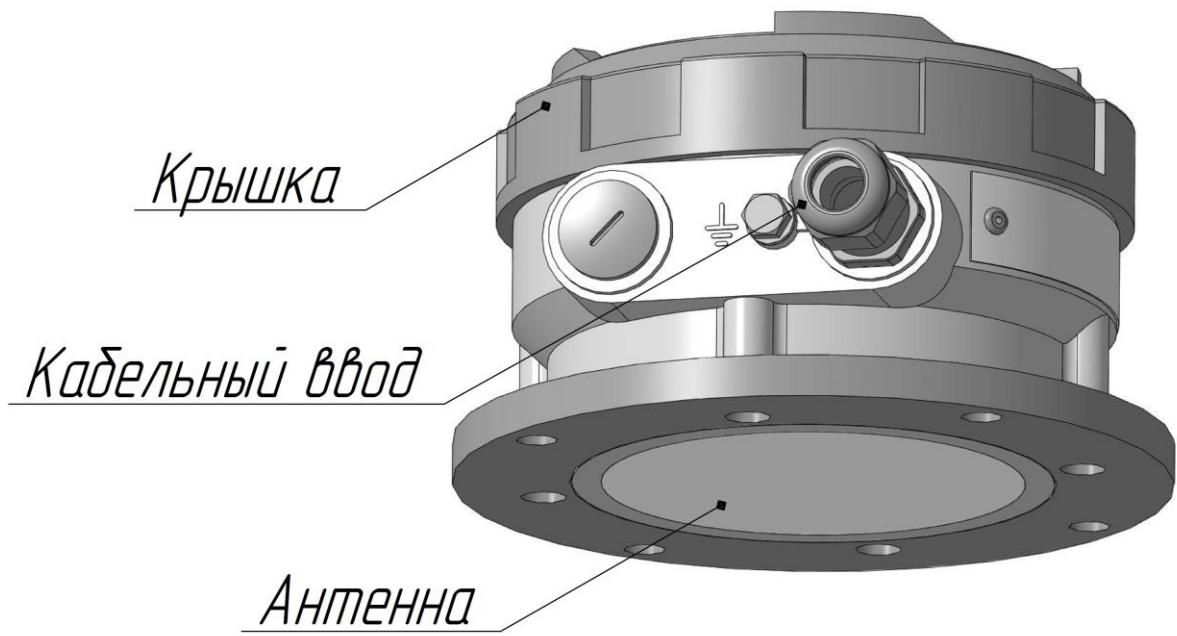
Рис. 3.2. Внешний вид и расположение основных элементов уровнемера УЛМ-31А1.
