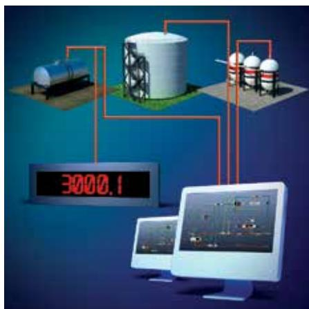
В зависимости от требуемой точности измерения, в каждом конкретном резервуаре могут использоваться различные уровнемеры. При этом все датчики уровня подключаются на одну информационную линию и работают с одним программным обеспечением верхнего уровня. Что, в результате, позволяет построить оптимальную по соотношению цена/качество систему измерения уровня.
