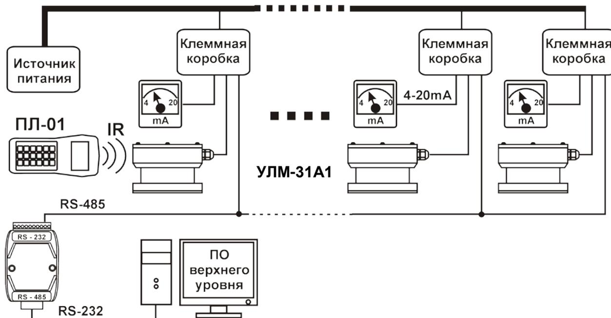
Рис.4.1. Пример построения системы измерения уровня на базе уровнемера УЛМ-31А1.
