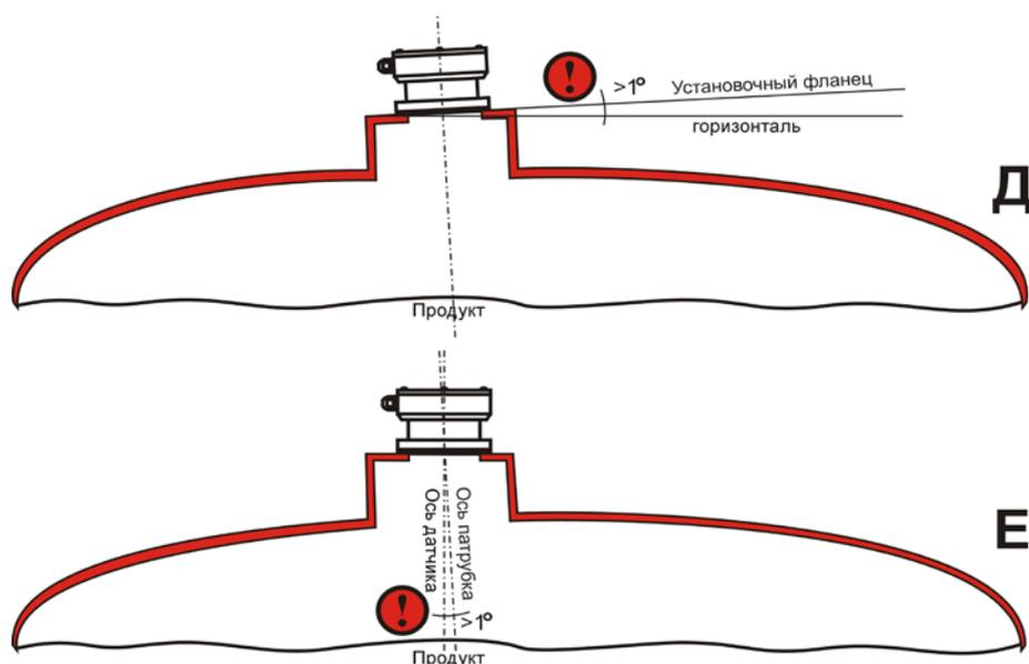
Рис.7.3 Примеры неправильного монтажа уровнемера.
