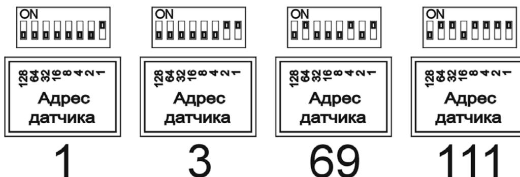
Рис.12.2. Примеры установки различных Modbus адресов.
